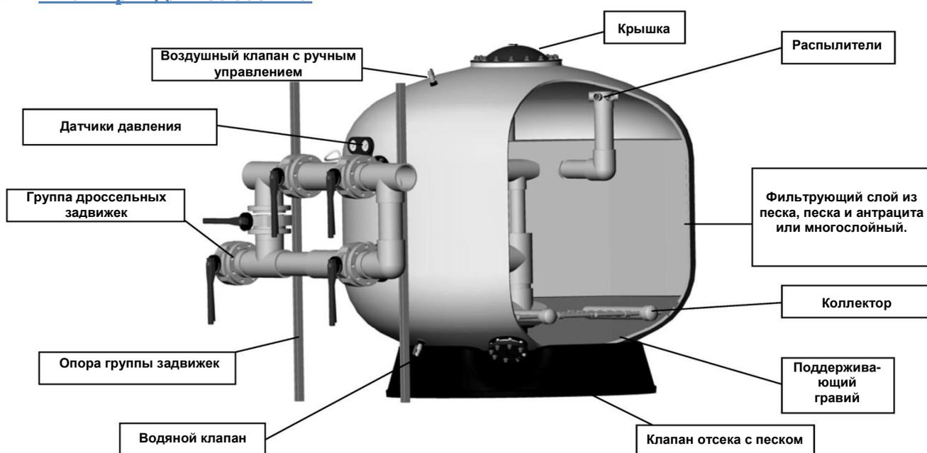
Фильтры, без сомнения, являются самой важной частью процесса очистки воды. Их предназначение – удаление взвесей, которые загрязняют воду.
