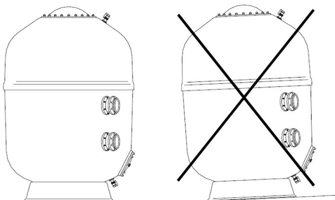
**Установите фильтр на строго горизонтальной поверхности**
